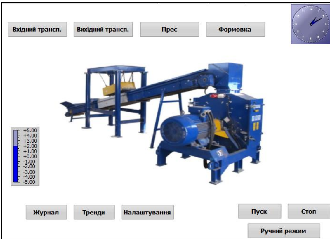
Рисунок 2 – Робоче вікно оператора SCADA-системи
