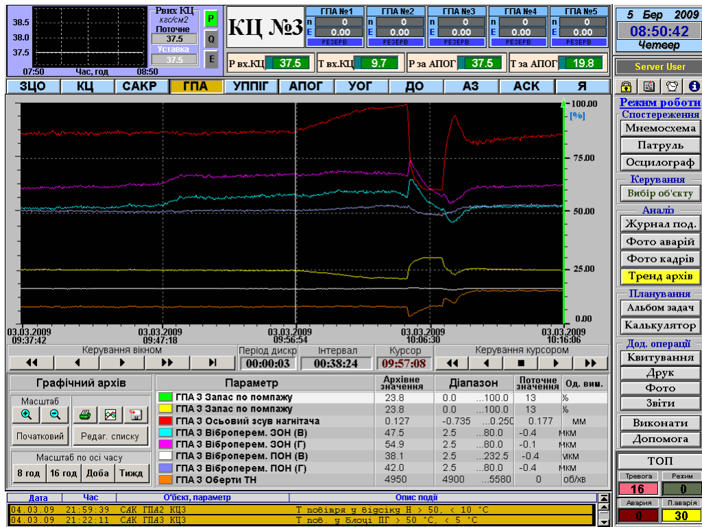
Рисунок 1 – Тренд технологічних параметрів роботи ГПА-Ц-16С при помпажній ситуації на КС-3 Долинського ЛВУМГ
